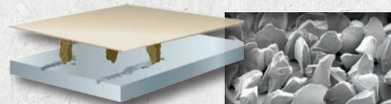
Negli abrasivi ceramici tradizionali i grani sono irregolari. Questo provoca durante la lavorazione del metallo un forte sviluppo di calore, riducendo la capacità di taglio e la durata del prodotto.
